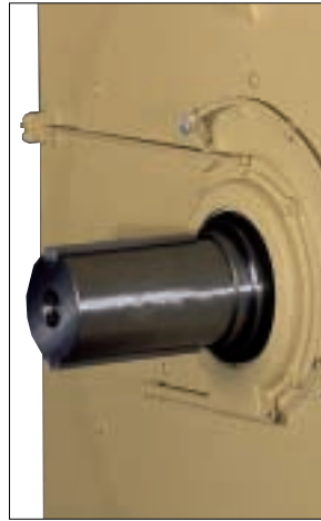
Wälzlager mit Nachschmiereinrichtung und Fettentnahmevorrichtung
