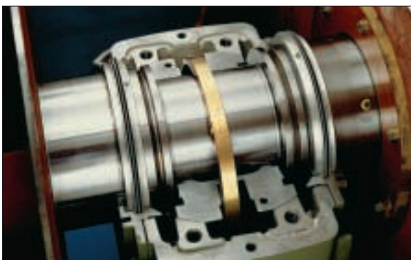
Gleitlagerausführung mit Eigenkühlung
