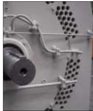
Wälzlager mit Nachschmiereinrichtung und Fettentnahmevorrichtung
