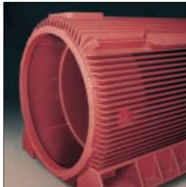
Gehäuserohling der Achshöhe 560
