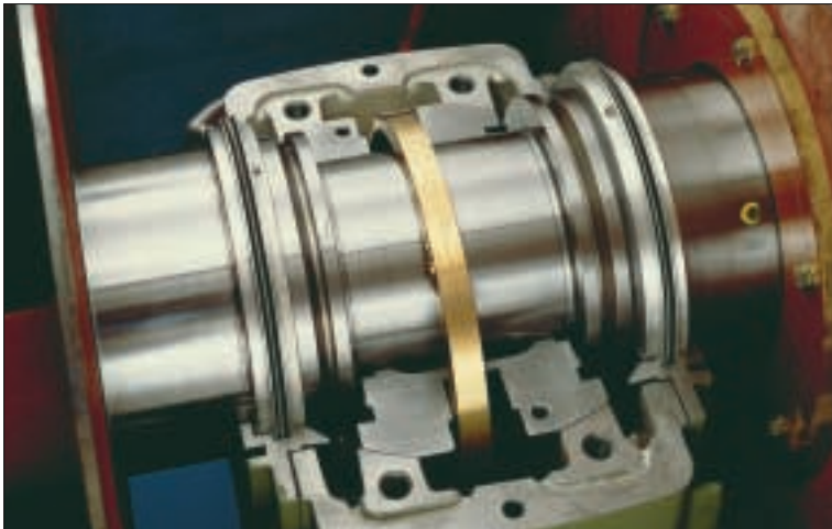
Gleitlagerausführung mit Eigenkühlung
