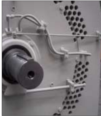
Wälzlager mit Nachschmiereinrichtung und Fettentnahmevorrichtung
